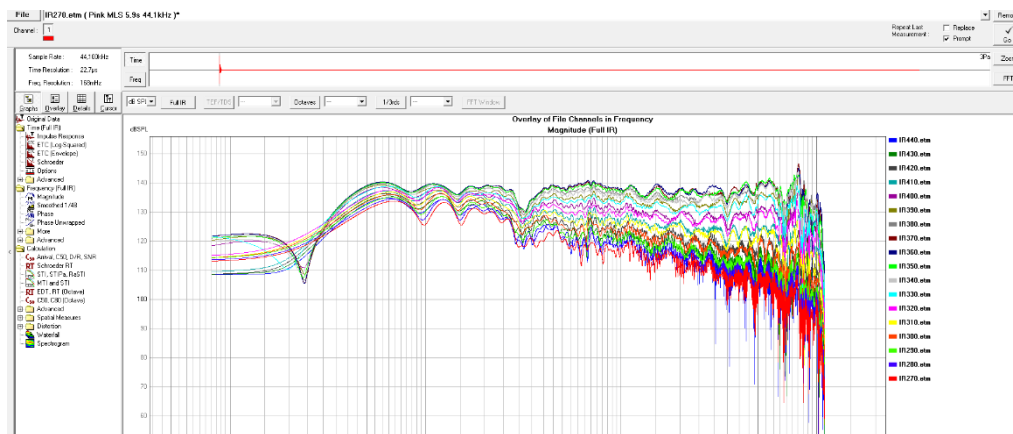
Abbildung 24: Überlagerung der Frequenzgänge, nachdem die Impulsantwort gefensterst wurde. Jede Messung wird mit einer anderen Farbe dargestellt. Die spektrale Unschärfe ist deutlich bei tiefen Frequenzen zu erkennen.
