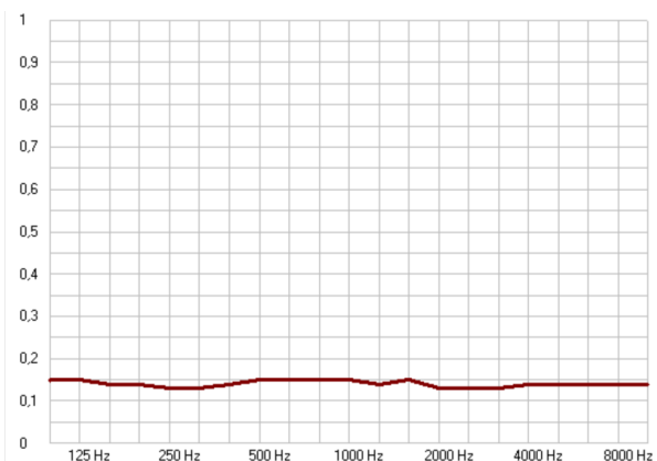
Abbildung 27: Absorptionsdiagramm des benutzerdefinierten Materials "Backstein offenporig"
