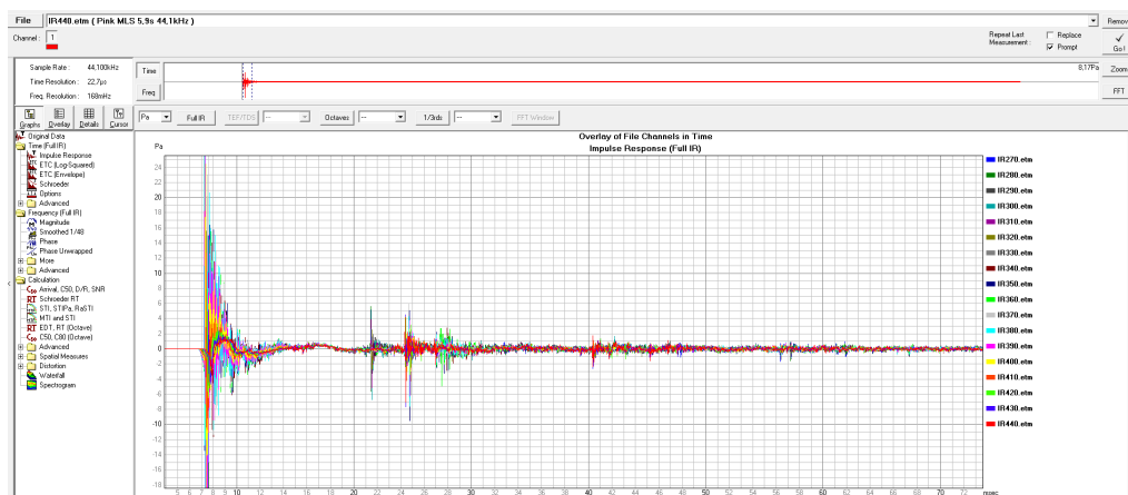
Abbildung 22: Überlagerung der Impulsantworten aller Messungen. Jede Messung wird mit einer anderen Farbe dargestellt. Die Impulsantwort wurde noch nicht gefenstert. Die Schallreflexionen sind ab 20 ms deutlich zu erkennen und müssen entfernt werden.
